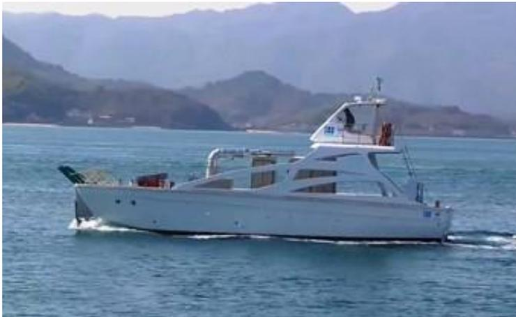
Um exemplo é o de uma embarcação movida por duas pilhas de combustível de 30 Kw da Ballard Power Systems, testada com êxito no Japão num projeto dirigido pela Yanmar, em que os módulos foram fornecidos pela Toyota Tsusho. Para o teste, foi utilizado um sistema de energia híbrido uma bateria de lítio de 60kWh e os dois módulos FCveloCity-MD produzindo um total de 60 kW de potência.
